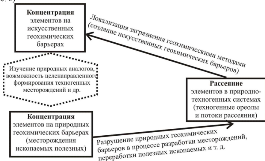
Рис. 2. Схема создания искусственных геохимических барьеров для охраны окружающей среды (на примере разработки месторождений полезных ископаемых)
